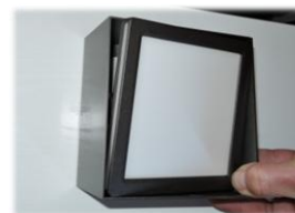
LED- Einheit an Magnet andocken oder wieder lösen
